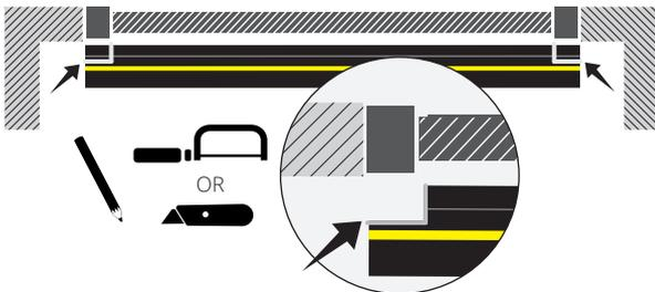
⑤ Positionieren Sie bei geschlossenem Tor die Bodenabdichtung so, dass der erhabene Teil die innere, untere Kante des Tors berührt.
