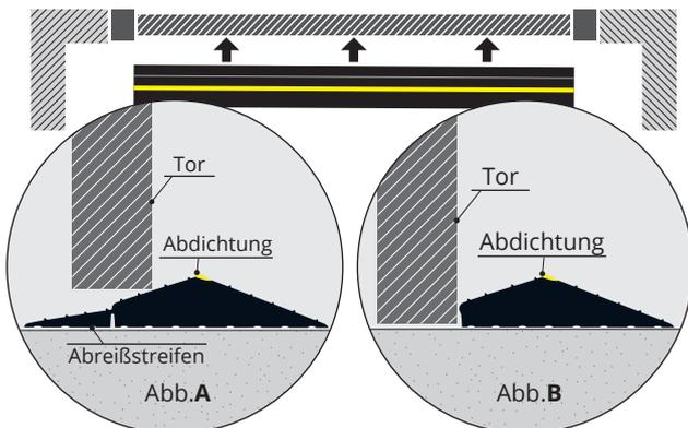
Falls der Spalt unter dem Tor zu schmal ist, reißen Sie den vorderen Streifen ab, um eine gerade Kante zu erzeugen, über der sich das Tor schließt (Abb. B)
