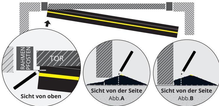
*Falls der Spalt unter dem Tor zu schmal ist, reißen Sie den vorderen Streifen ab, um eine gerade Kante zu erzeugen, über der sich das Tor schließt (Abb. B)*
